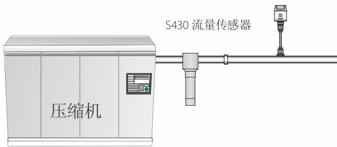
空压机排气量测量和FAD流量自动计算
