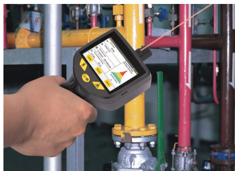
用激光指示器进行远距离泄漏检测
