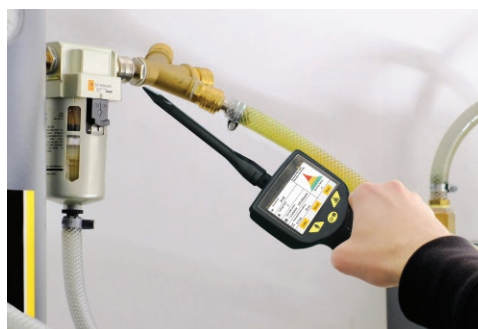
带聚焦管进行泄漏检测
